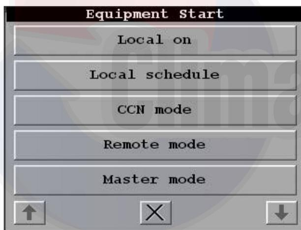
La pantalla de puesta en marcha de la unidad (Fig. 6) permite seleccionar el tipo de funcionamiento.
