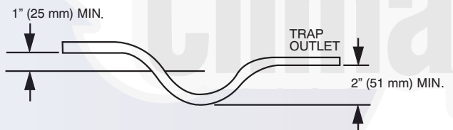
Fig. 7 - Condensate Trap
