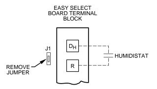
Fig. 15—Humidistat Wiring for De-Humidify Mode
