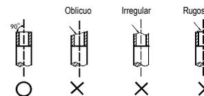
4.1.2 Utilice un escariador para eliminar la rebaba. Asegúrese de cortar con la superficie hacia abajo para que no entren pedazos a la tubería.
