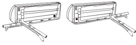
Tape el orificio de drenaje sin utilizar, con el tapón de goma incluido.
