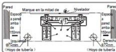
2. Abra un hoyo de tubería de  $\Phi 55$  o  $\Phi 70$  de diámetro en la posición elegida. Para que drene de forma adecuada, incline el hoyo de tubería en la pared hacia abajo del lado exterior con gradiente de 5-10°.
