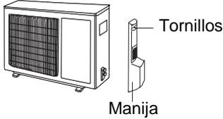
2. Remueva la tapa del tornillo de la válvula y dirija la unión de tubería a la boca de campana de la tubería.
