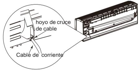
3. Remueva el clip de cable, conecte el cable de corriente a la terminal de cableado de acuerdo al color; asegure el tornillo y luego ajuste el cable de corriente con el clip de cable.
