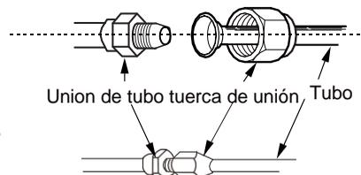
3. Ajuste el torque de acuerdo a la siguiente hoja. Ubique la llave de horquilla en la unión de tubo y la llave de torque en la tuerca de unión. Apriete la tuerca de unión con la llave de torque.
