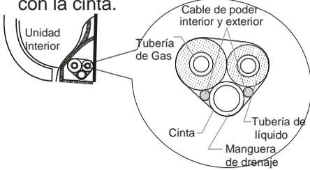
2. Reserve una cierta longitud de manguera de drenaje y cable de poder. Cuando vende a un ángulo específico, separe el cable de poder y la manguera de drenaje.
