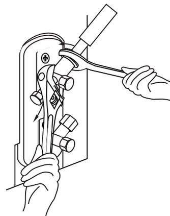
5. Mientras sujeta firmemente el cuerpo de la válvula, utilice una llave dinamométrica para apretar la tuerca de abocardado de acuerdo con los valores correctos de par de apriete
