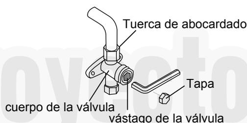
12. Usando una llave hexagonal, abra completamente las válvulas de alta y baja presión.
