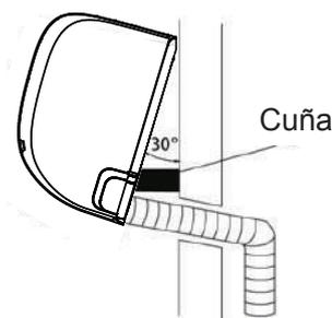
3. Conecte la manguera de drenaje y la tubería de refrigerante (consulte la sección Conexión de la tubería de refrigerante de este manual para obtener instrucciones).
