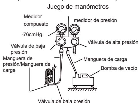
6. Cierre el lado de baja presión del manómetro y apague la bomba de vacío.
