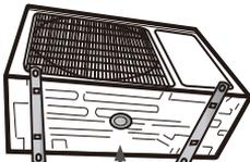
Vent. drenaje — Unión de drenaje exterior
