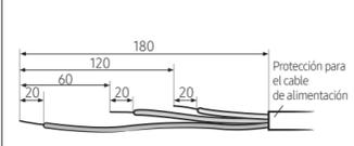
3 Inserte ambos lados del hilo principal del cable de alimentación en el manguito de conexión.
