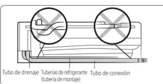
3 Conecte a la manguera de desagüe principal una extensión de manguera de desagüe con diámetro interior de 15,88 mm.
