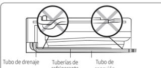
En el Paso 2-2, paso 3, determinó la posición de salida del haz de tubos. La unidad tiene tres orificios ciegos disponibles para las salidas izquierda, derecha e inferior. Cuando el haz sale directamente de la parte trasera, no se utiliza ninguno de estos orificios ciegos.
