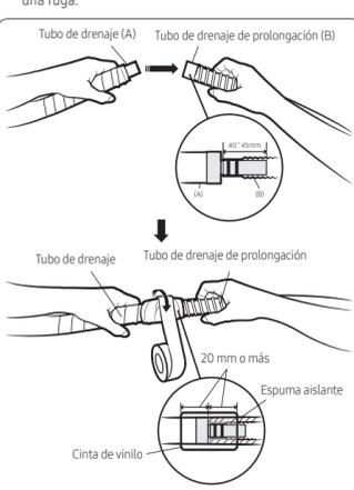
4 No cubra la conexión de la manguera de desagüe. Debe estar accesible para realizar pruebas más adelante en el proceso de instalación y para el mantenimiento futuro.
