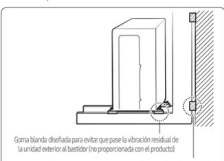
Goma blanda diseñada para evitar que pase la vibración residual de la unidad exterior al bastidor (no proporcionada con el producto)
