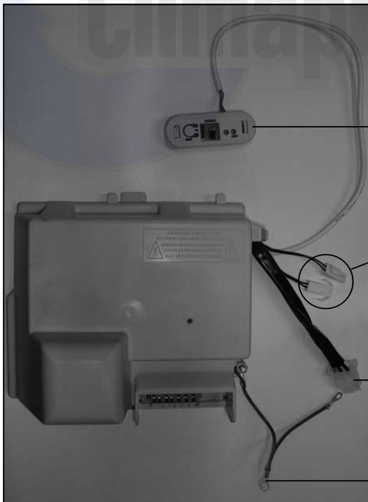
Receptor de la señal del control inalámbrico.
