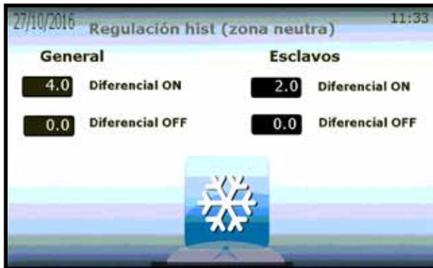
La unidad tiene la opción de configurar el encendido y apagado respectivo desde el punto de ajuste, tanto para el modo de enfriamiento como para el de calefacción, en "General" el diferencial ON tendrá el valor de ON y el diferencial OFF el valor de OFF, siempre respecto al punto de ajuste de la unidad.
