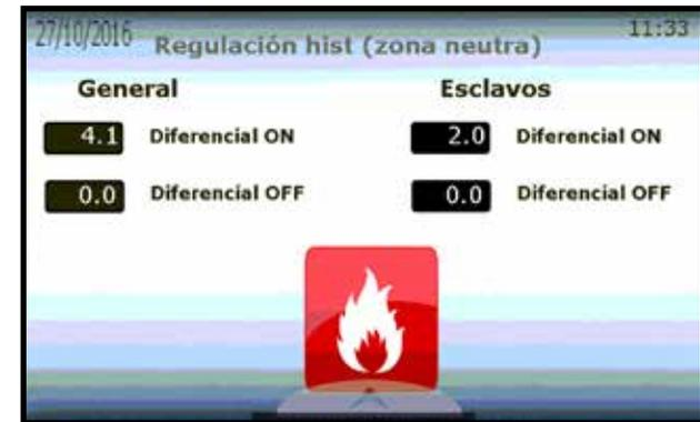
Además en el apartado de "Hijo" es posible configurar el encendido y apagado de los mismos, esta configuración es una prevención para evitar la alarma de congelamiento o agua fría en el modo "Tandem", esta función es la misma que en "General" y respectiva al punto de ajuste
