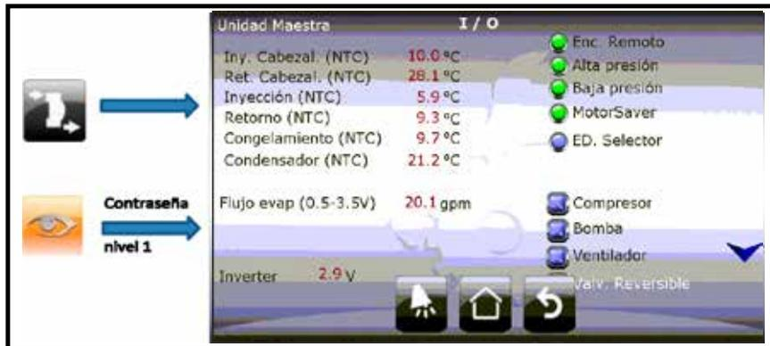
Para una Unidad Enfriadora de Agua de Bomba de Agua de calor se mostrarán las salidas de temperatura del condensador y del condensador de flujo.
