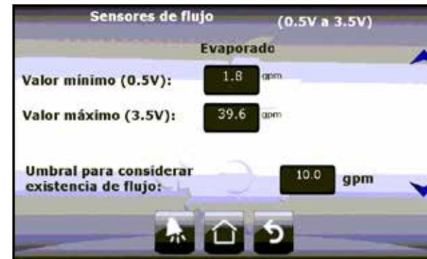
Este tipo de sensores no pueden medir más de 39.6 gal/min, en caso de que obtenga un valor mayor a este, se desplegará en la pantalla 295.6 aprox. Revise su sistema hidráulico para regular el flujo.
