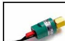
ACB / LCB es un pequeño control de presión tipo disco para su uso en refrigeración y sistemas de aire acondicionado. Como norma, está equipado con un sistema de contacto 6ª con reinicio manual o automático. El control es robusto y confiable en la operación de diferentes tipos de unidad.
