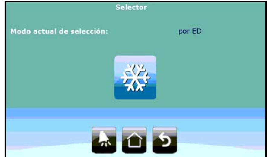
La selección del modo de funcionamiento puede ser configurado de 2 maneras: Mediante una entrada digital o seleccionándolo en la terminal (Sección de "Configuración"). Si ya se ha seleccionado el modo de trabajo mediante entrada digital cualquier otra selección en la terminal será ignorada. Si el modo de trabajo ha sido seleccionado por el usuario en la terminal, solo podrá ser editado o cambiado en esta pantalla, ignorando el estado de la entrada digital.
