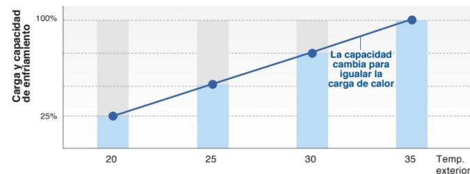
La capacidad requerida cambia a medida que cambia la carga del aire acondicionado, según la temperatura exterior.
