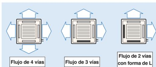
\* Para instalar un flujo de 3 o 2 vías, se debe usar material de sellado para cerrar cada salida de descarga de aire (opcional) que no se use.
