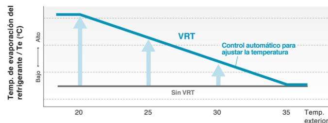
En el caso de temperatura de evaporación fija, el enfriamiento es excesivo, y hay pérdida térmica durante el encendido/apagado y otras ineficiencias.
