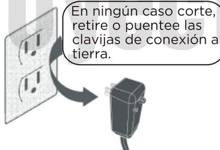
Cable de alimentación con enchufe de 3 clavijas con toma a tierra y dispositivo de detección de corriente.
